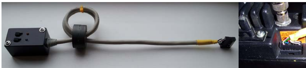
Эхо-репитер, как отдельное устройство. Светодиоды индицируют включение устройства (зелёный) и включение передачи (красный). Переключатели включают/выключают репитер и громкоговоритель трансивера.
