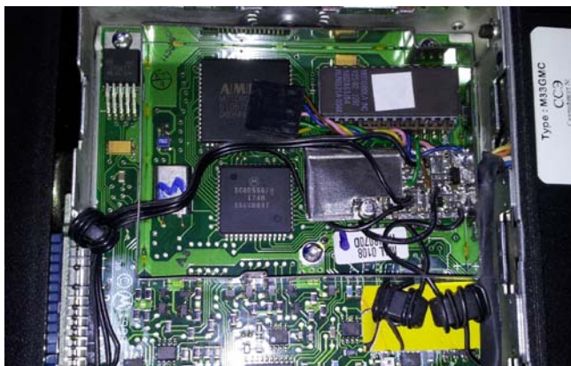
Пример размещения эхо-репитера внутри трансивера Motorola GM-300
